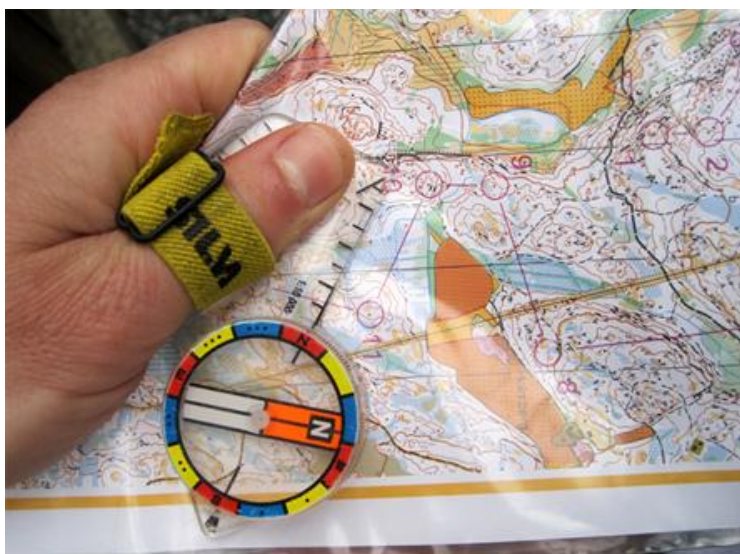
Tommelkompass med fast kompasshus og farge- og prikkkoding for himmelretninger.
