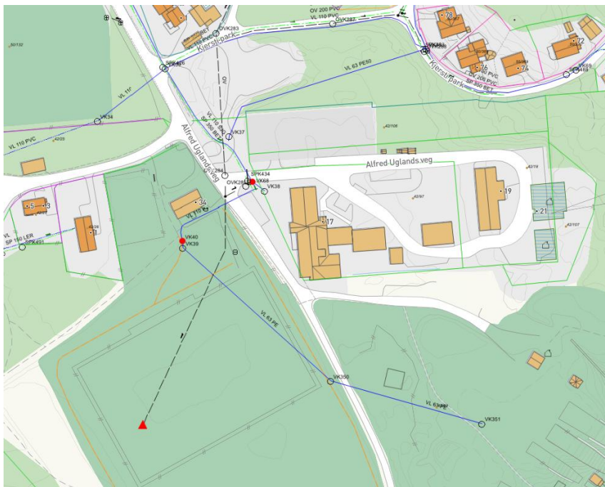
Figur 5: Kartutsnitt som viser ca plassering av vann og avløpsledninger i området.
